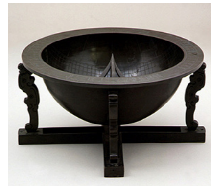
세종 시기 가장 널리 보급된 해시계이다. 햇빛에 의해 그림자가 생겼을 때 그림자의 위치로 시간을 측정하는 장치로써 시각을 12지신으로 표시하여 백성들이 쉽게 시간을 읽을 수 있었다.
