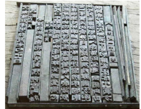
갑인년에 주자소에서 만든 동활자이다. 활자의 모양이 바르고 글자의 크기가 고르며, 자판의 빈틈을 대나무를 이용하여 글자가 선명하고 아름답다. 하루에 활자를 찍어 내는 양이 40여 장에 달하여 경자자보다 배 이상의 생산력을 가질 수 있었다.
